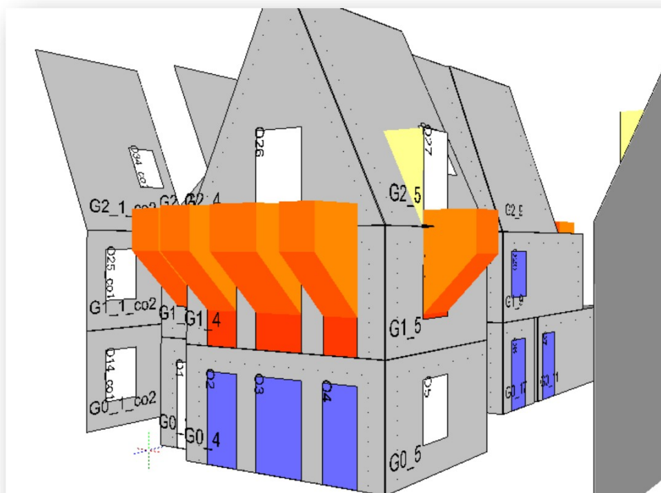
Figuur 3: Aanzicht van appartement 2 brandend, vanuit rechter-/voorzijde gezien.
